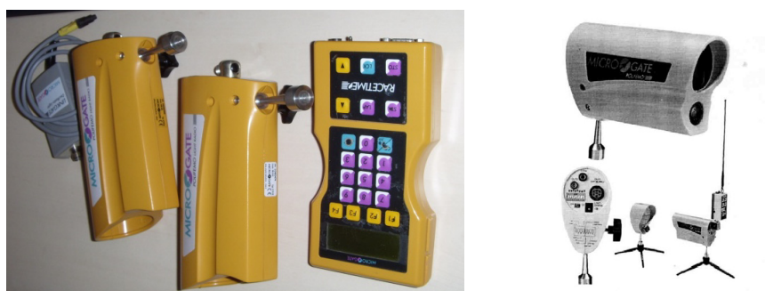
Рис. 2.12. Microgate система для автоматического измерения скорости
